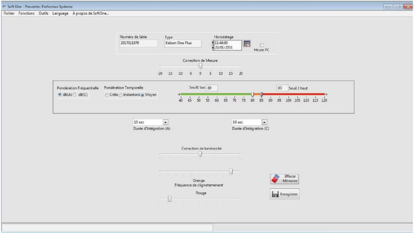
Selectionner le mode de mesure Instantané ou Moyen via les boutons radio en haut à droite. Modifier les réglages désirés puis enregistrer les réglages à l'aide du menu
